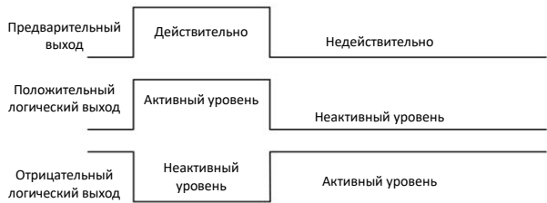
Рисунок 7-14 Диаграмма положительной и отрицательной логики цифрового выходов
