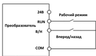
(a) Схема подключения двухпроводного управления (F00.03=0)
