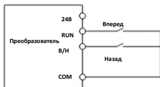
(c) F00.03=1 подключение двухпроводного управления
