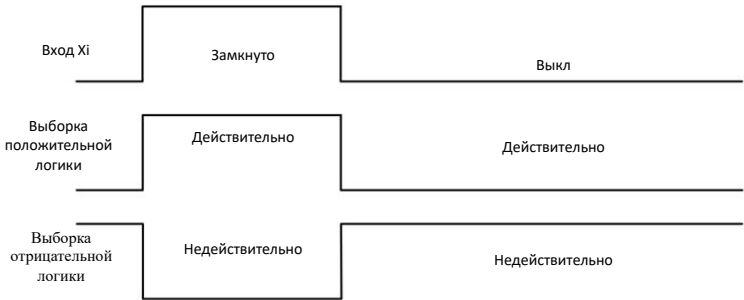
Рисунок 7-12 Диаграмма положительной/отрицательной логической выборки клеммы
