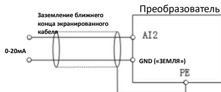
Рисунок 3-13 Схема подключения внешнего источника тока и клеммы AI2
